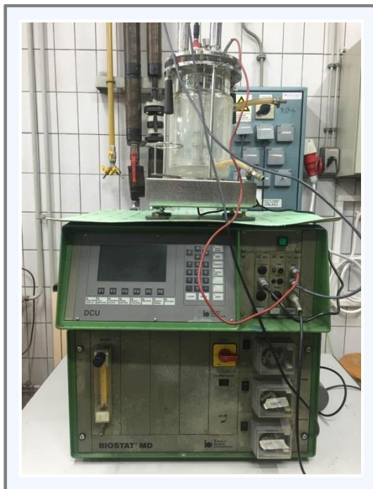
Slika 5. Bioreaktor s miješalom (Biostat MD, B. Braun, Njemačka) (vlastita fotografija)
