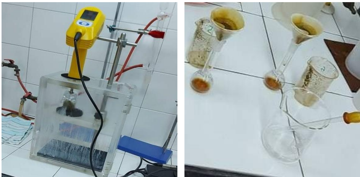
Slika 6. Ultrazvučna ekstrakcija i filtracija ekstrakata (vlastita fotografija)
