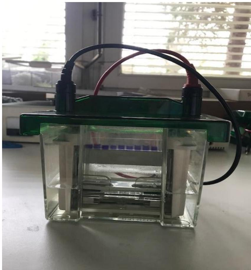
**Slika 3.** Sastavljeni modul za elektroforezu priključen na struju
