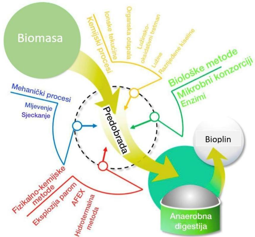
**Slika 4.** Metode predobrade s ciljem povećanja bioraspoloživosti lignocelulozne biomase (prema Rajendran i sur., 2018)
