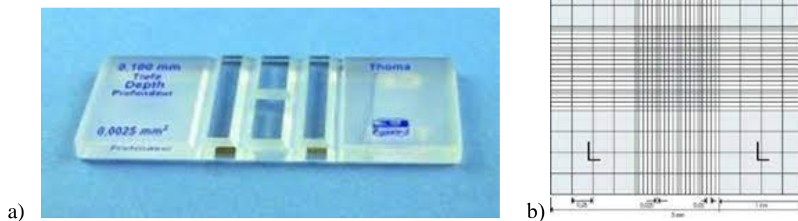
Slika 2. a) Neubauerova komorica, b) mreža komorice (KEFO Croatia, 2022)
