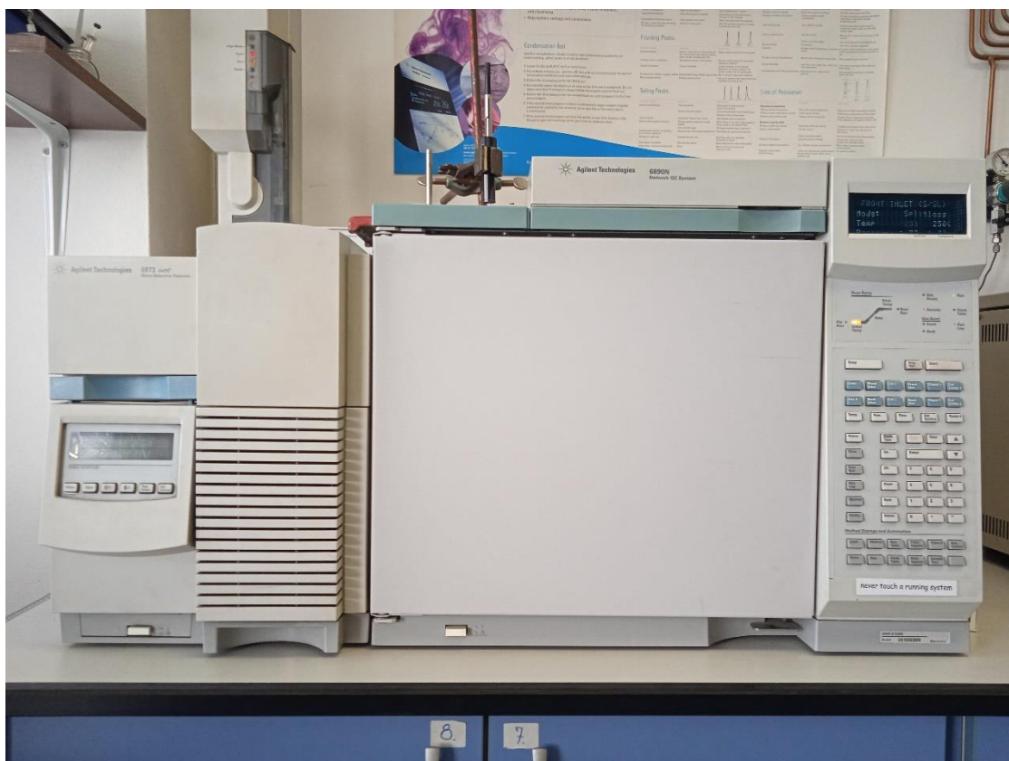
Slika 8. Plinski kromatograf kromatografu Agilent Technologies 6890N Network GC System (vlastita fotografija)
