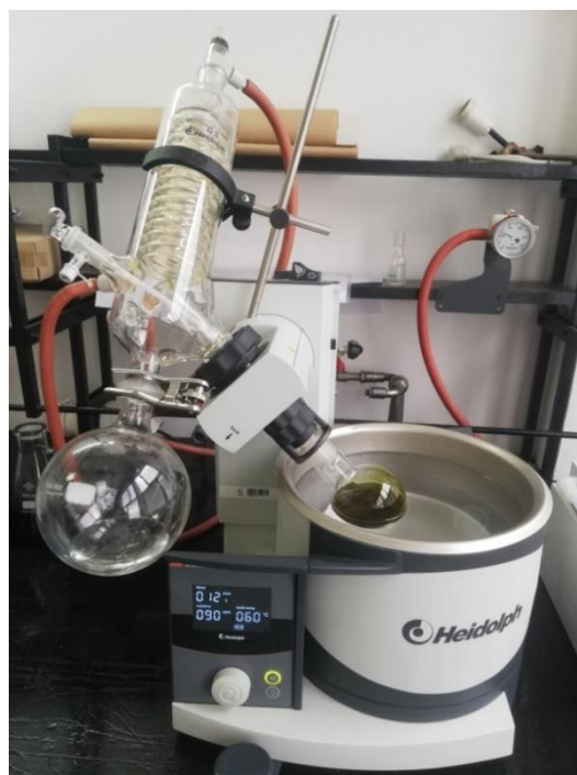
Slika 6. Uparavanje ekstrakta na rotirajućem uparivaču (osobne fotografije)
