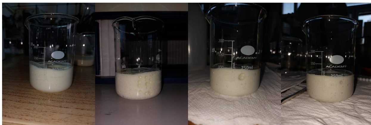
a) b) c) d) Slika 19. Usporedba izgleda pjena nakon 15 minuta miksiranja pri a) pH 3, b) pH 5, c) pH 7 i d) pH 9 (Vlastite fotografije)
