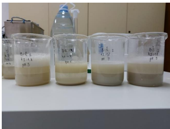
Slika 10. Izgledi emulzija pri različitim pH vrijednostima kod omjera proteina i škroba 70:30 (Vlastita fotografija)
