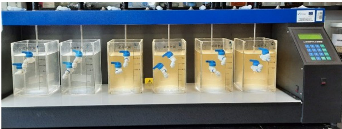
Slika 2. Flokulacija vode u JAR testeru u laboratoriju na Prehrambeno-biotehnološkom fakultetu.
