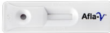
Slika 14. Afla-V ONE kvantitativni test za određivanje količine aflatoksina u uzorku (Waters, 2022)
