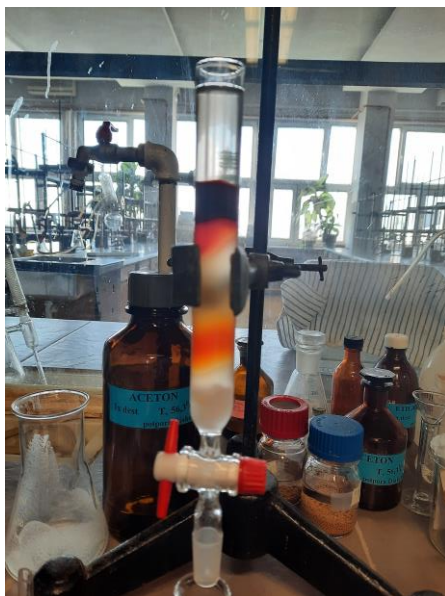
Slika 17 Primjer kromatografske kolone na stupcu od silika gela (vlastita fotografija)
