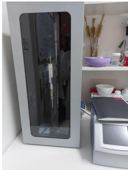
**Slika 3.** Ultrazvučni aparat Q700CA Sonicator (vlastita fotografija)
