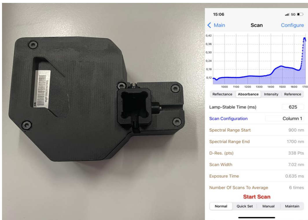
Slika 6. NIR spektroskopija s on-line praćenjem
