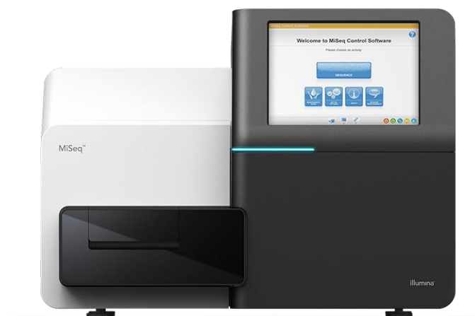
Slika 4. Illumina MiSeq uređaj koji se koristi za sekvenciranje DNA (Illumina, 2022)
