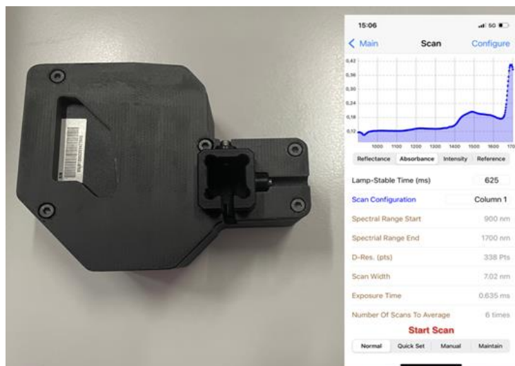
Slika 3. Mikro NIR instrument (Ćorić, 2023)
