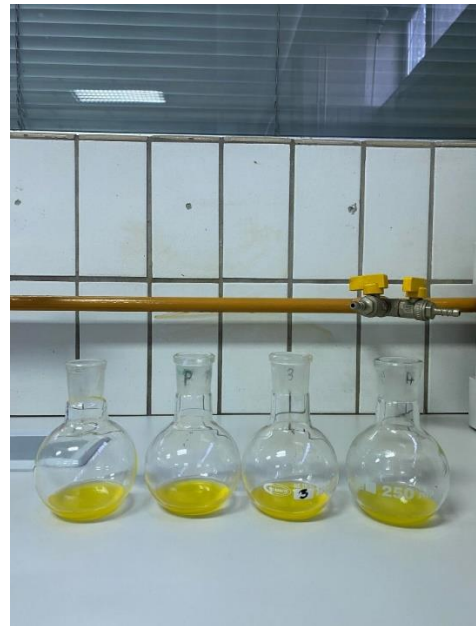
Slika 6. a) Odvajanje faza nakon centrifugiranja u Falcon epruvatama; b) Odvojena organska faza u tikvicama (vlastite fotografije)
