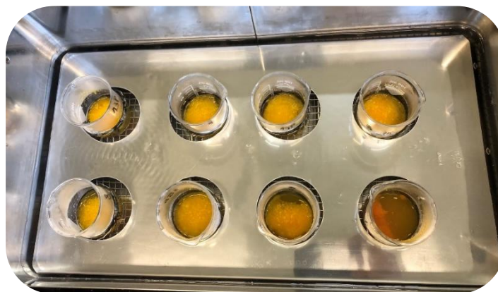
Slika 4. Ekstrakcija uzorka u ultrazvučnoj kupelji ( vlastita fotografija )
