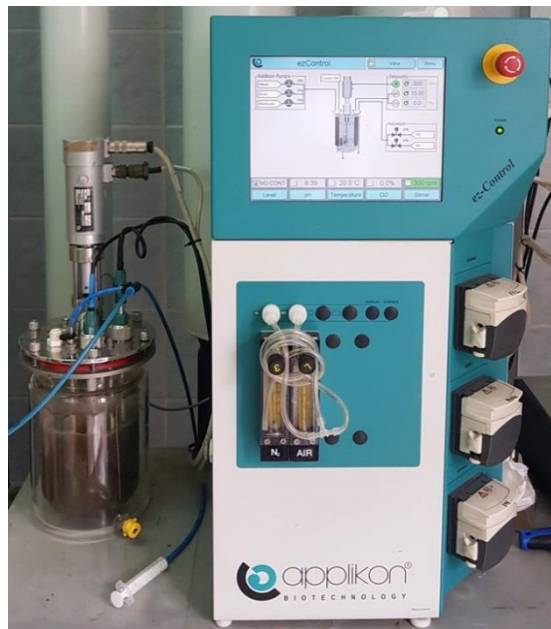
Slika 10. SBR tvrtke „Applikon“ (vlastita fotografija)
