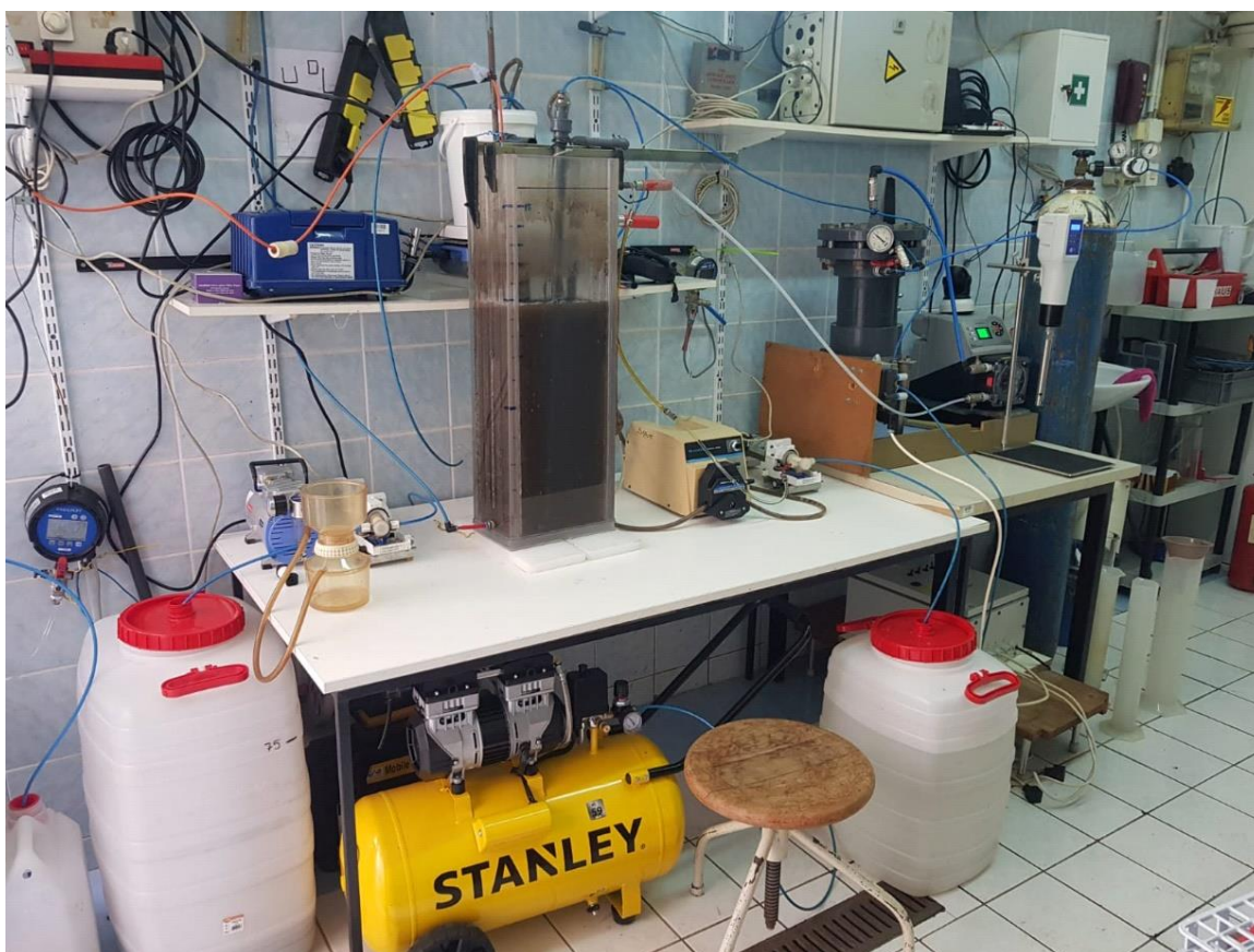
Slika 15. Laboratorijski MBR uređaj (vlastita fotografija)
