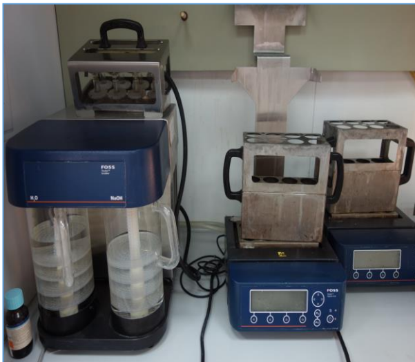
Slika 15 Blok za razaranje (Unit 8 Basic, Foss)
