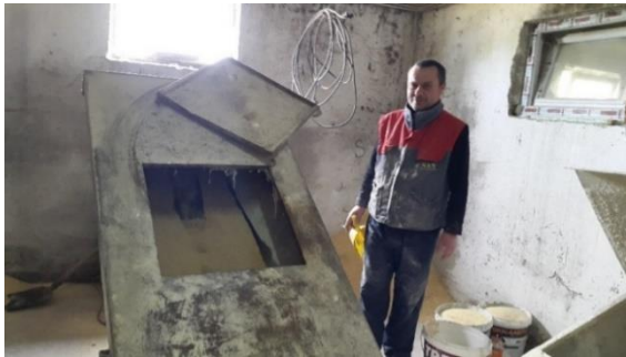
Slika 9 Zamješavanje hrane u pužnoj mješalici (foto: Gross – Bošković, A., 2021.)
