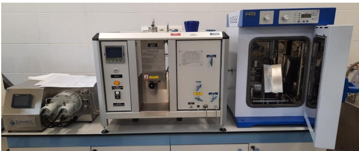
Slika 5. Uređaj za ekstrakciju superkritičnim CO 2 (vlastita fotografija)
