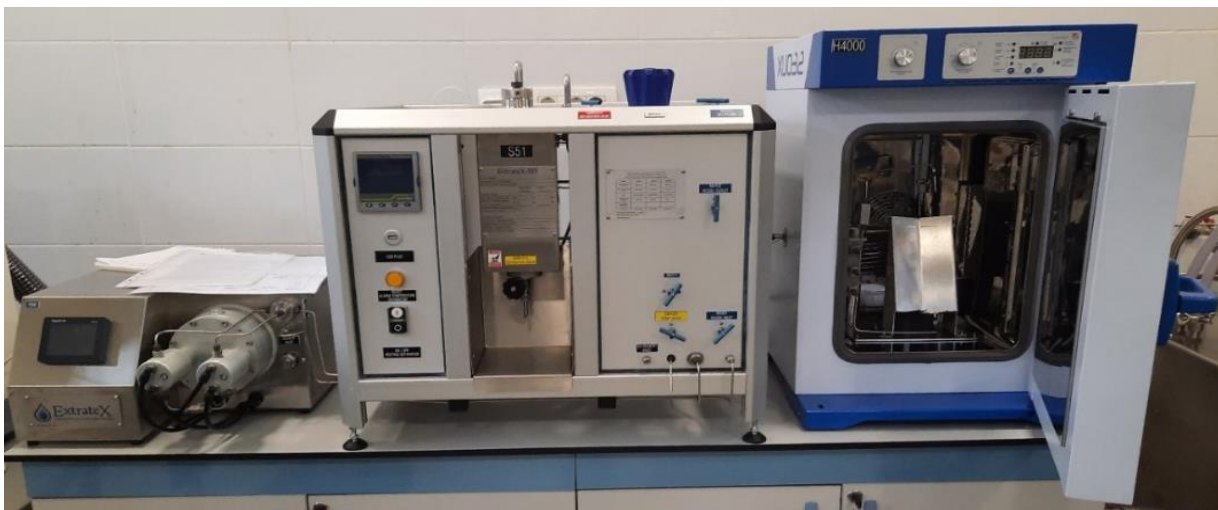
Slika 5. Uređaj za ekstrakciju superkritičnim CO 2 (vlastita fotografija)
