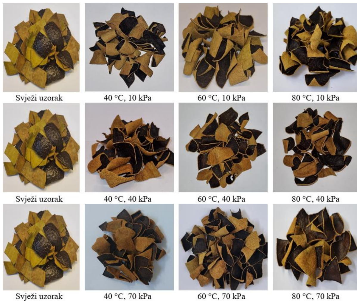
Slika 12. Fotografije svježe kore avokada i sušene u vakuum sušari pri različitim uvjetima temperature i tlaka
