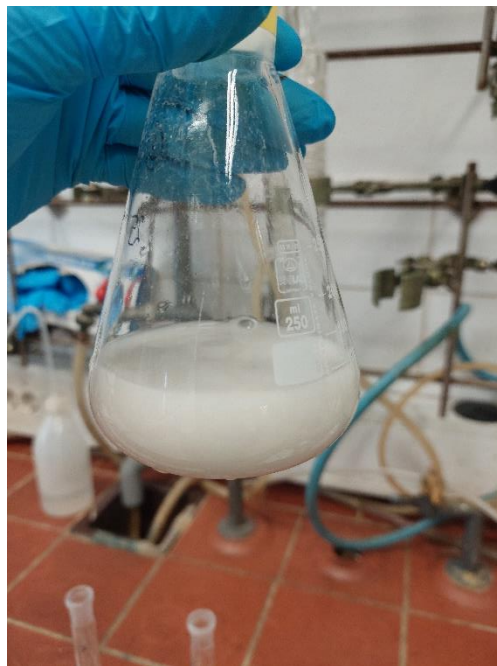
Slika 3. Boja uzorka nakon titracije otopinom natrijevog tiosulfata ( vlastita fotografija )
