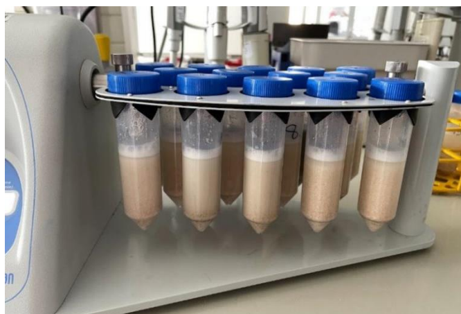
Slika 8. Uzorci nakon miješanja na „ head-over-head “ rotirajućoj miješalici
