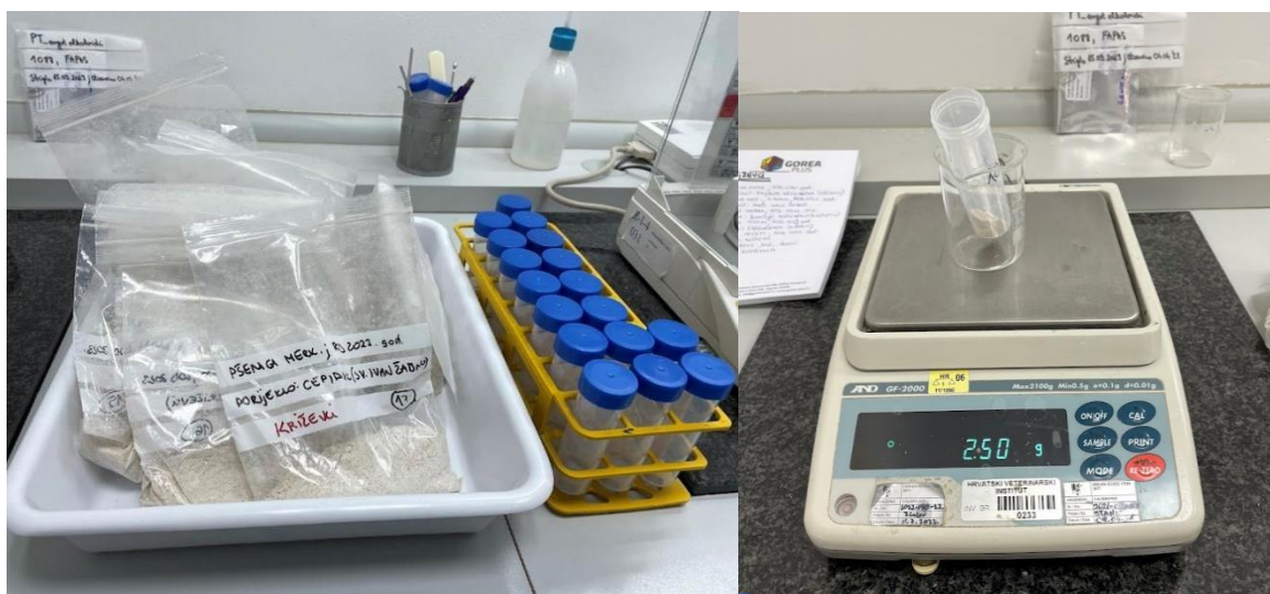
(a) Homogenizirani uzorci spremni za vaganje; (b) Odvaga uzorka u konusnu epruvetu
