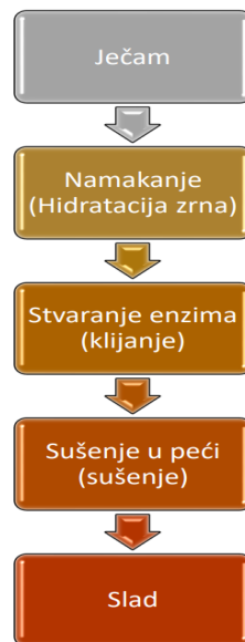
Slika 1. Tipičan proces proizvodnje slada (Stewart, 2016)
