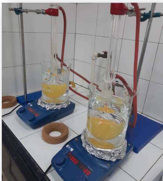
Slika 3. Aparatura za refluksiranje (vlastita fotografija)
