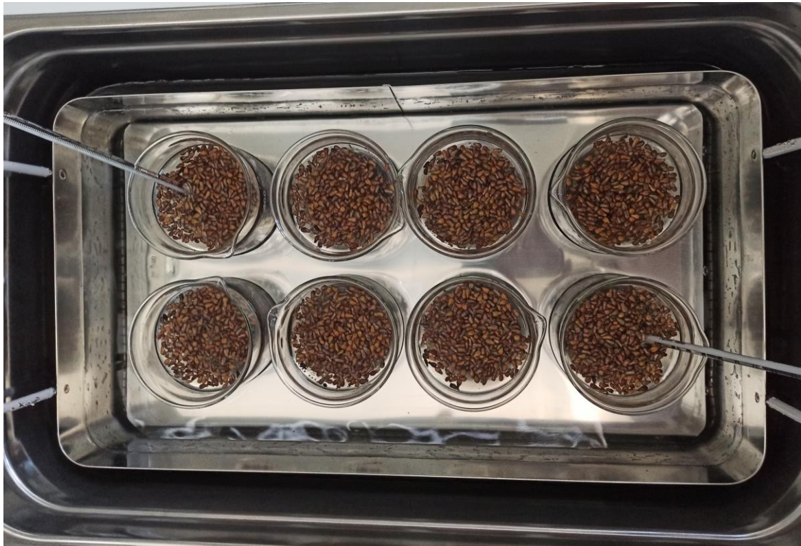
Slika 1. Ultrazvučna kupelj s uronjenim laboratorijskim čašama s uzorkom sjemenki grožđa (vlastita fotografija)
