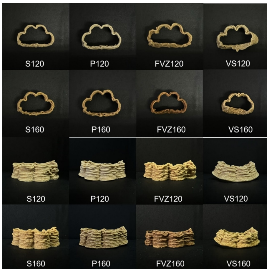
Slika 10. Fotografije uzoraka nakon završne obrade različitim tehnikama i temperaturama ( vlastita fotografija )
