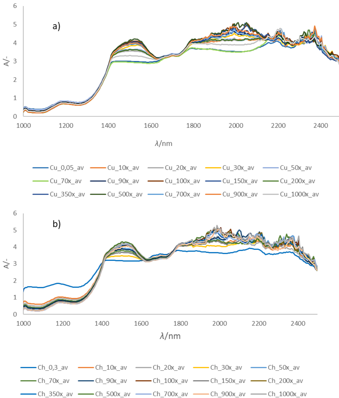
Slika 6. Izvorni NIR spektri pripremljene originalne otopine/suspencije fungicida (a) Cuprablau Z 35 WG (0,05 Cu) i (b) Chromosul 80 (0,3 Ch) te njihovih odgovarajućih razrjeđenja snimljenih pomoću spektrometra NIR AvaSpec-NIR256-2.5-HSC-EVO, Avantes, SAD ( \lambda = 1000 - 2500 nm)
