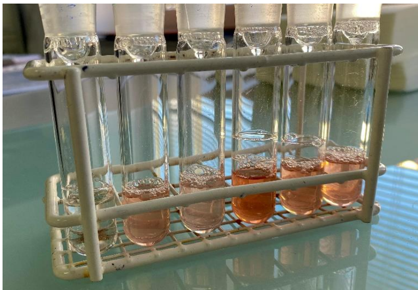
Slika 4. Razvijanje boje uzoraka prilikom određivanja sadržaja L-glutaminske kiseline ( vlastita fotografija )
