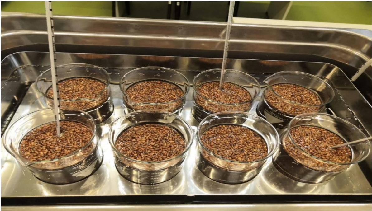
Slika 1. Predtretman sjemenki u ultrazvučnoj kupelji Elmasonic P, ( vlastita fotografija, 2024 )
