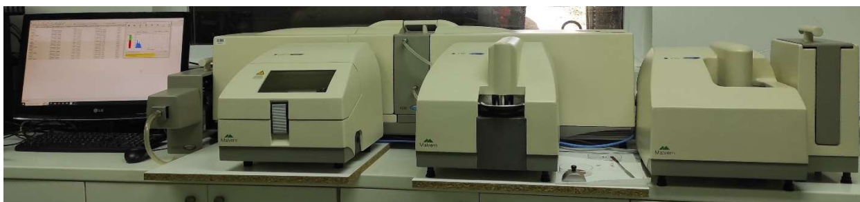
Slika 3. Malvern Mastersizer 2000 sa vanjskom jedinicom Hydro 2000S koja se nalazi u središtu (vlastita fotografija)
