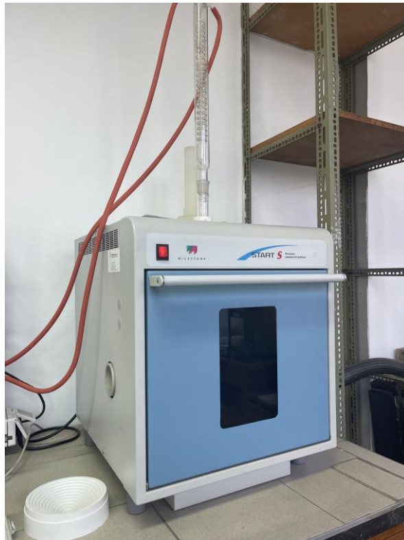
Slika 9. Mikrovalni reaktor Milestone Start S (vlastita fotografija)
