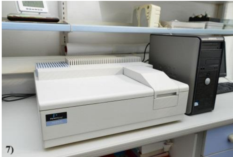
Slika 8. UV/Vis spektrofotometar Perkin Elmer Lambda 25 (TTF, 2024)
