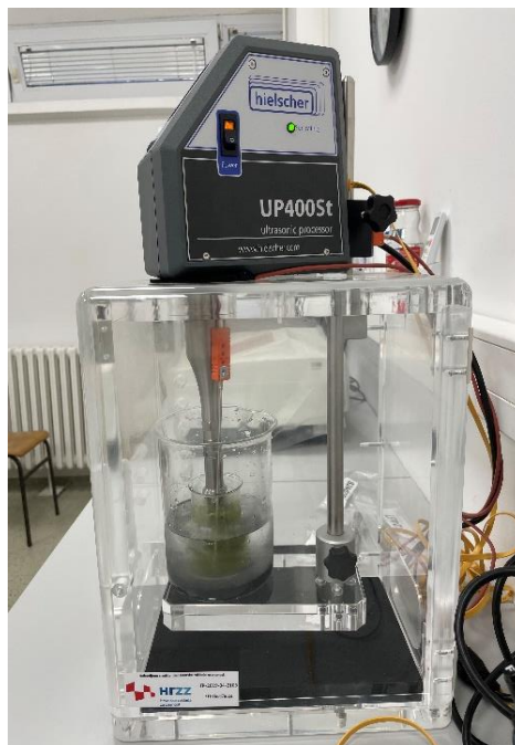
Slika 3. Postupak ekstrakcije lista planike uz pomoć ultrazvučnog procesora (vlastita fotografija)
