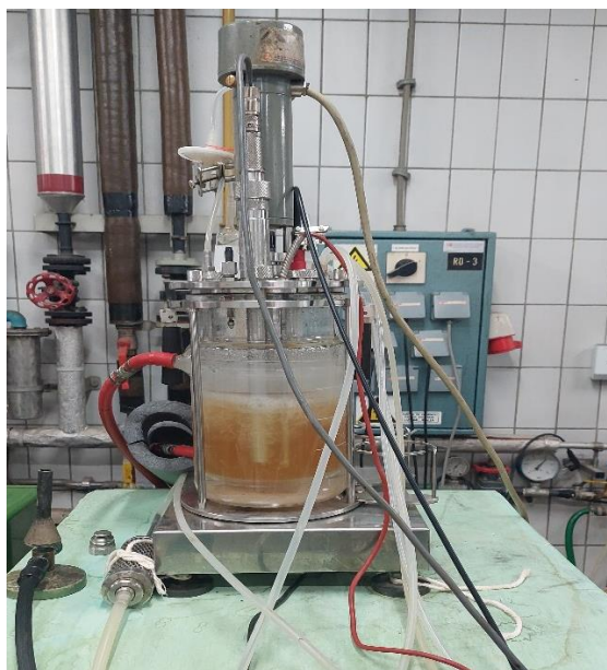
Slika 4. Bioreaktor s mješalom (B. Braun Biotech International, Berlin, Njemačka) (vlastita fotografija)
