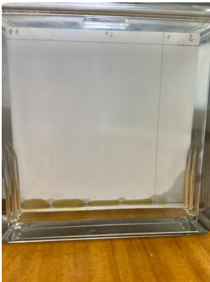
Slika 7. Razvijanje ploče za detekciju 2-monoacilglicerola (vlastita fotografija)
