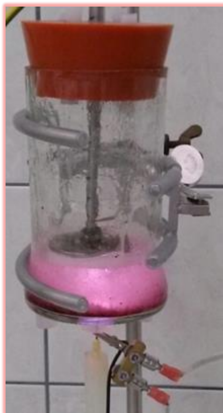
Slika 8. Reaktor ekstraktora tijekom postupka ekstrakcije hladnom plazmom
