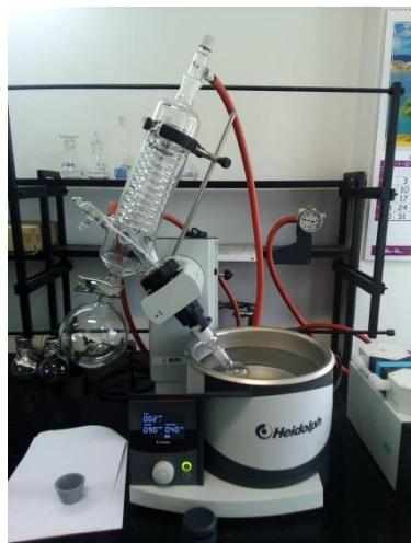
**Slika 6.** Otparavanje na rotavaporu (vlastita fotografija)
