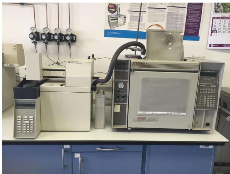
Slika 7. Plinski kromatograf (GC) s plamenoionizacijskim detektorom (FID) – Hewlett Packard HP 5890 (vlastita fotografija).
