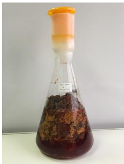
Slika 5. Erlenmeyerova tikvica sa vrelnjačom (Top King, dirigitirana fermentacija, 30^{\circ}\text{C} ) (vlastita fotografija).
