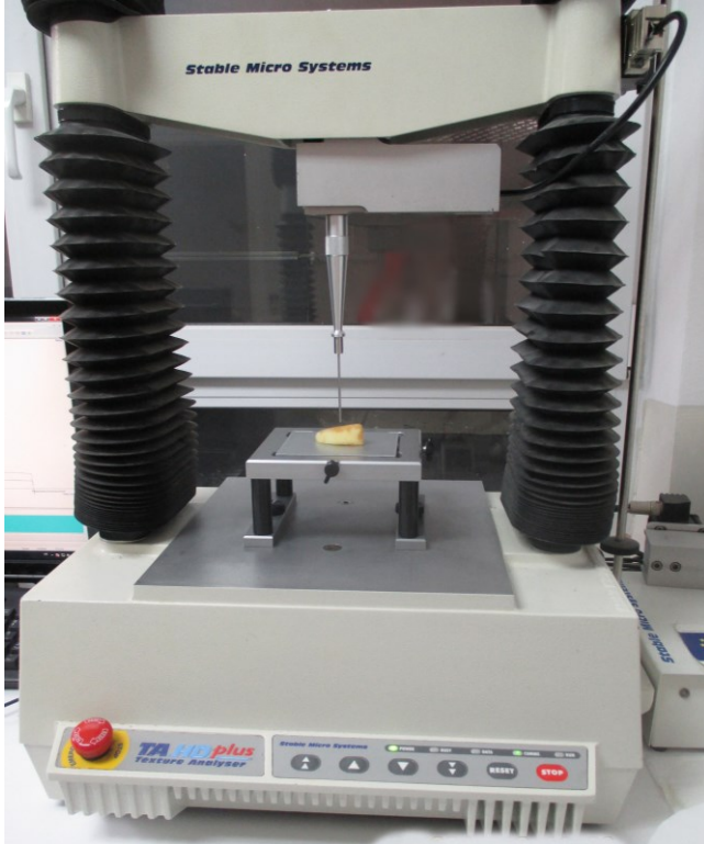
Slika 6. Teksturometar TA.HDPlus (Stable Micro System, UK)
