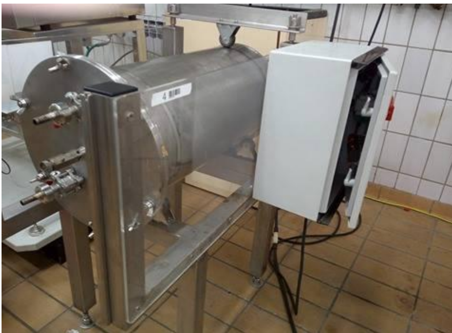
Slika 9. Horizontalni rotirajući cijevni bioreaktor
