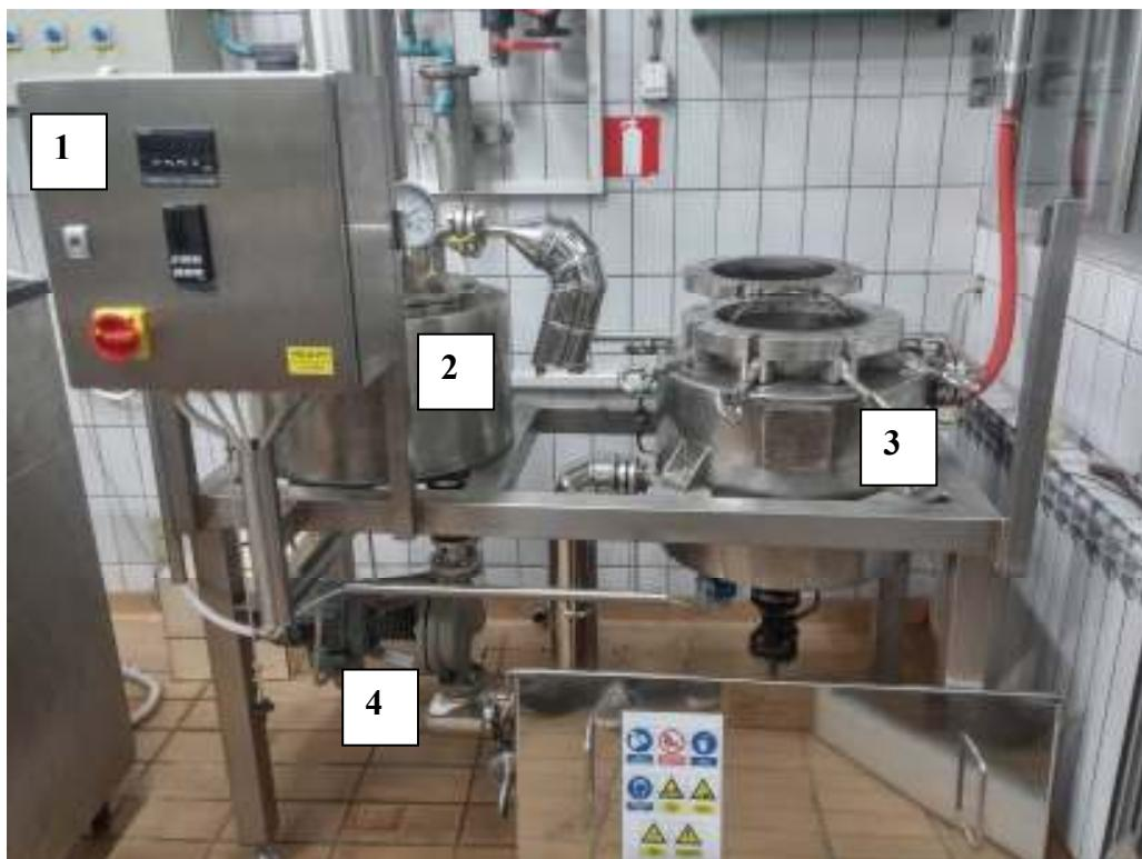
**Slika 8.** Visokotlačni reaktor za termičku predobradu lignoceluloznih sirovina
