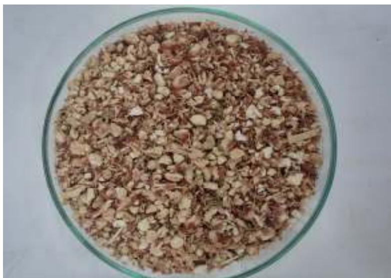
**Slika 6.** Kukuruzni oklasci usitnjeni na mlinu čekičaru.
