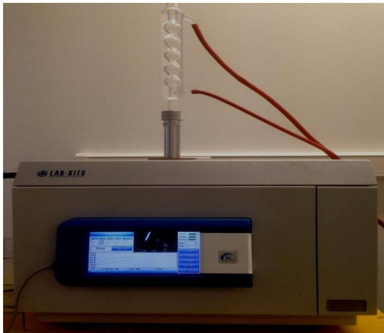
**Slika 6.** *Ultrazvučno – mikrovalni ekstraktor (vlastita fotografija)*
