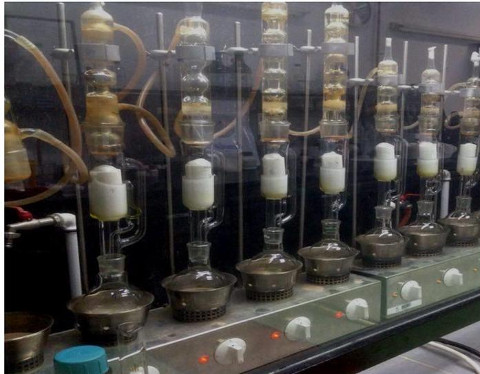
**Slika 5.** *Aparatura po Soxhletu (vlastita fotografija)*
