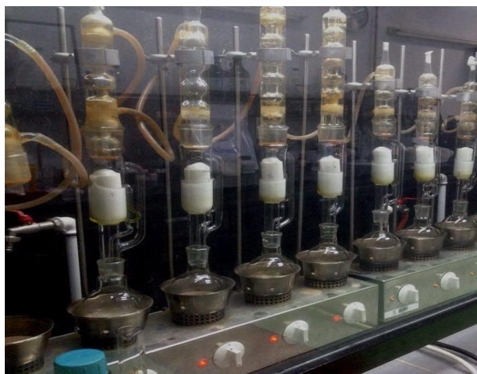
Slika 5. Aparatura po Soxhletu (vlastita fotografija)
