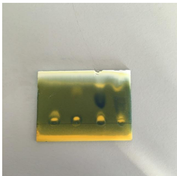
Slika 4. Praćenje tijeka jabučno-mliječne fermentacije tankoslojnom kromatografijom
