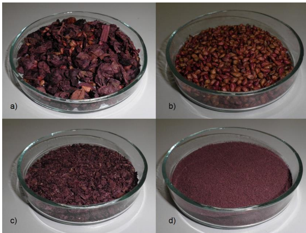
Slika 4. a) Liofilizirana komina (pokožica, sjemenke, peteljka); b) sjemenke grožđa; c) pokožica; d) samljevena pokožica
