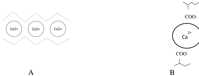
Slika 5. Prikaz modela „kutija za jaje“ (A). Ionska interakcija između divalentnog kationa, \text{Ca}^{2+} i karboksilne grupe iz alginata (B) (Racovića i sur., 2009)
