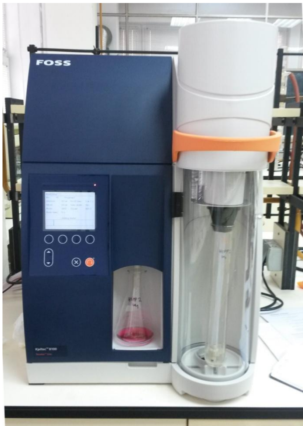
Fotografija Kjeltac uređaja s uzorkom u prvoj minuti destilacije
