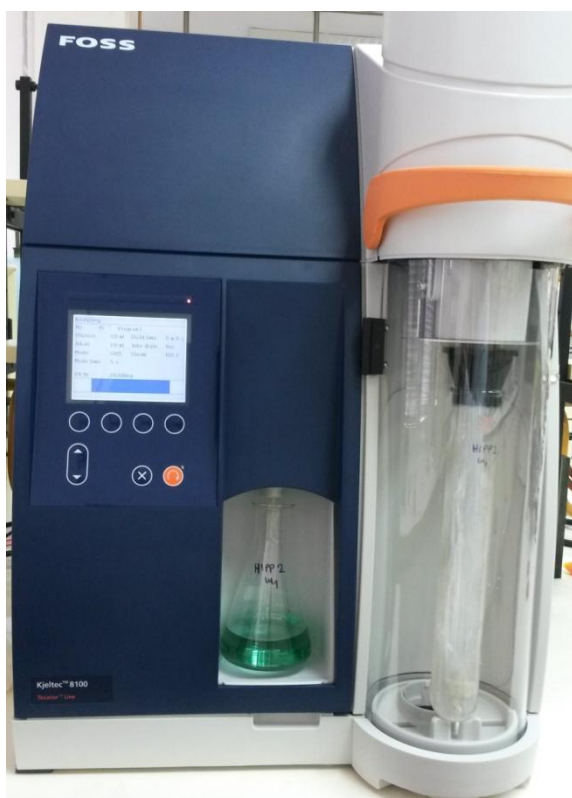
Fotografija Kjeltec uređaja s uzorkom u petoj minuti destilacije
