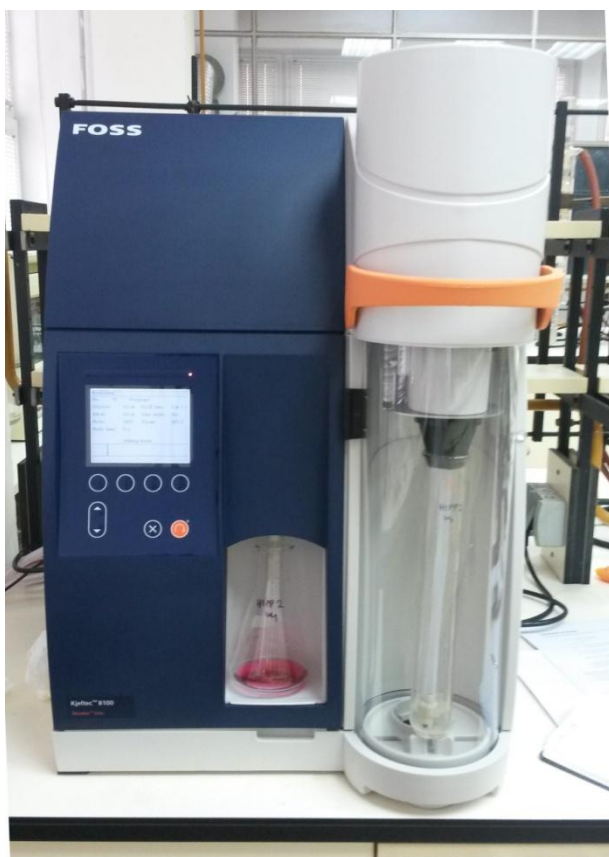
Fotografija Kjeltec uređaja s uzorkom u prvoj minuti destilacije
