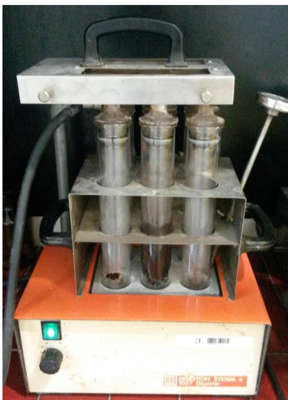
Fotografija spaljivanja uzorka
