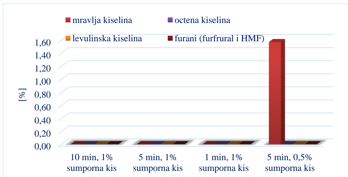
Slika 12. Udio mravlje kiseline (■), octene kiseline (■), levulinske kiseline (■) i furana (■) u čvrstoj fazi hidrolizata kukuruzovine nakon predobrade u visokotlačnom reaktoru kod različitih uvjeta
