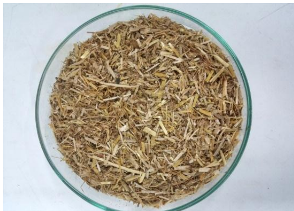
Slika 8. Pšenična slama usitnjena mlinom čekičarom
